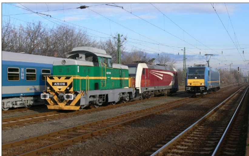
8. ábra Dunakeszin a hibrid vontatás egy dízel és egy villamosmozdony együtt (fotó: Murárik László)
