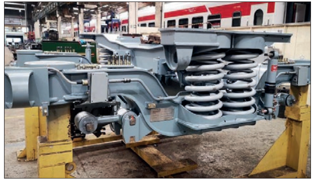
3. ábra: Hímával szerelt forgóváz
