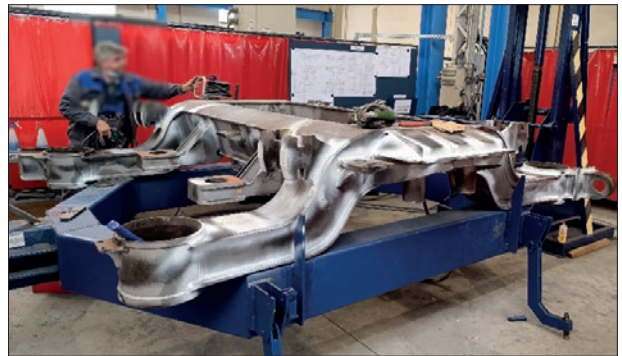
4. ábra: Forgóvázkeret UT, MT vizsgálata
