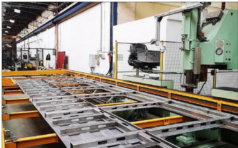
7. ábra: Oldalfalgyártás ellenállás ponthegeztő gépen
