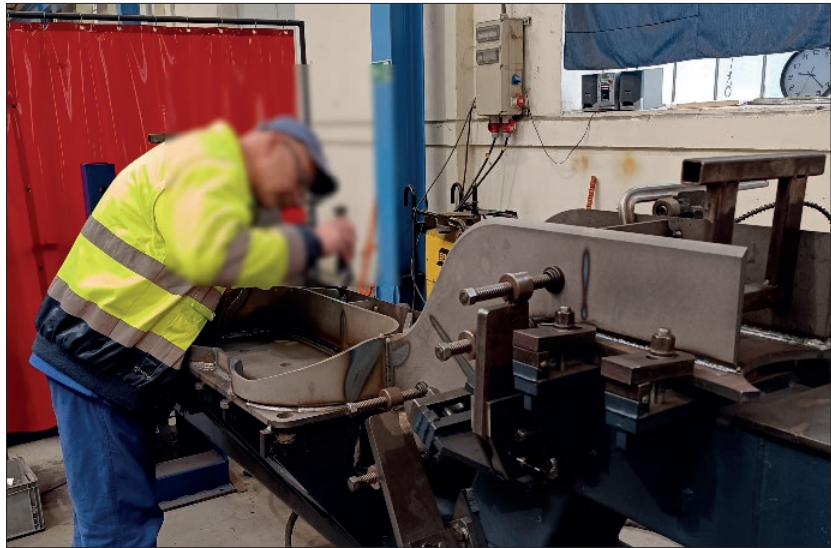
5. ábra: Hegesztések gyártásközi ellenőrzése
