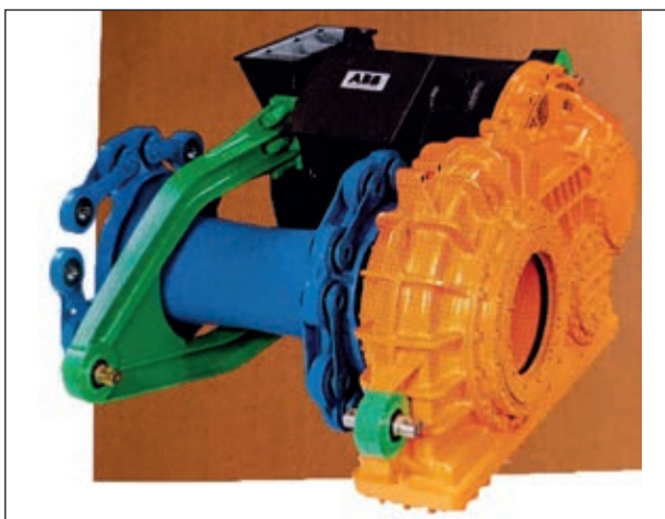
8. ábra: Vontatómotor és integrált hajtás
