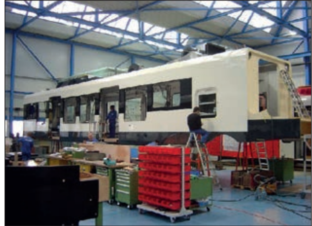
12. ábra FLIRT motorkocsi a végszerelési csarnokban Abb. 12 : FLIRT Triebwagen in der Endmontagehalle Fig. 12 : FLIRT motor coach in the final assembly hall
