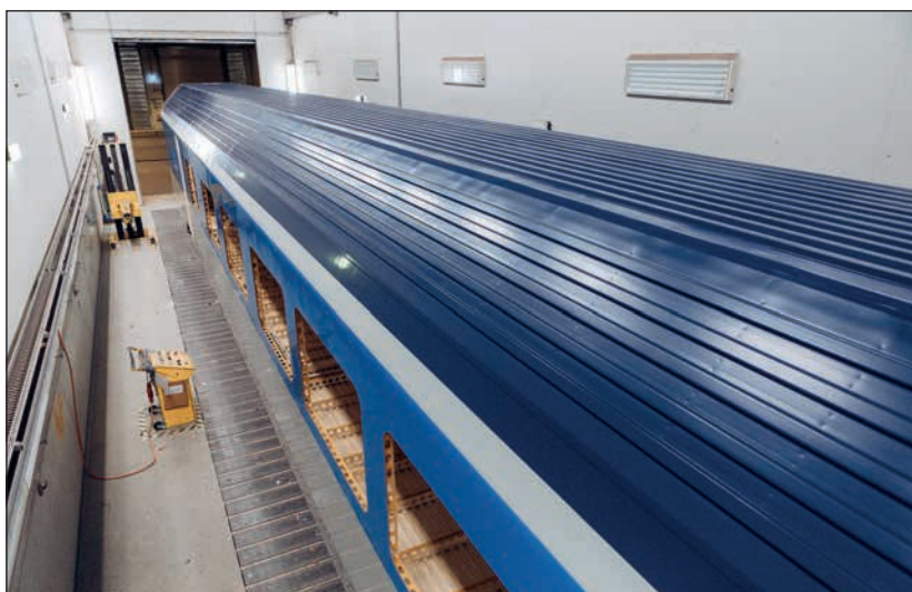
5. ábra: Alapfestett kocsiszekrény. (Forrás: Siemens Mobility)
