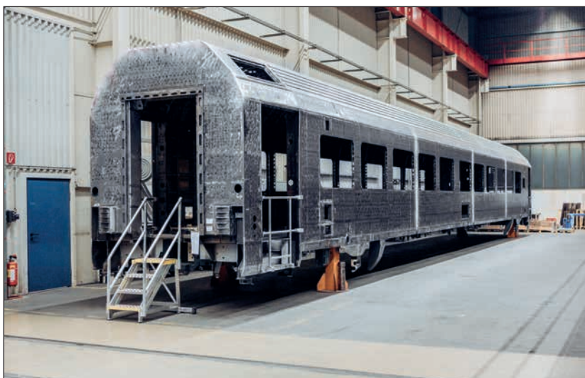
3. ábra: Lemezelt szekrényváz. (Forrás: Siemens Mobility)
