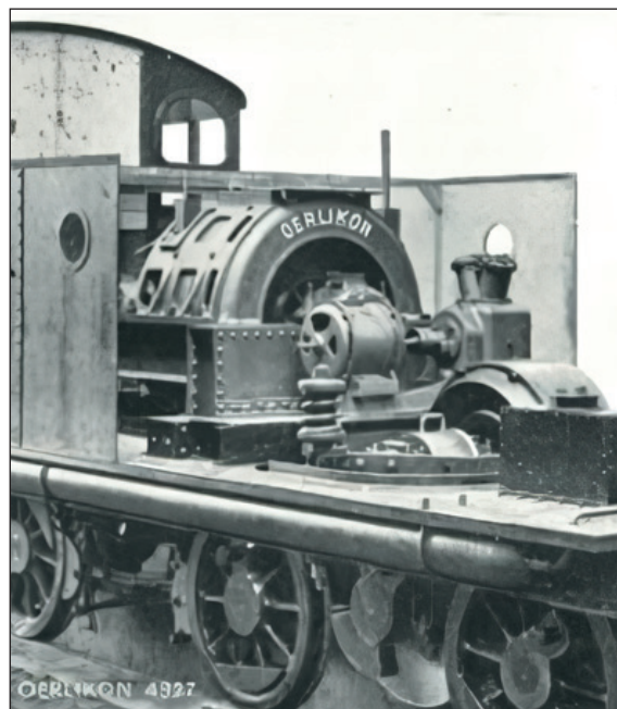
7. ábra: 400 kW teljesítményű egyfázisú-egyenáramú forgó átalakító gépcsoport
