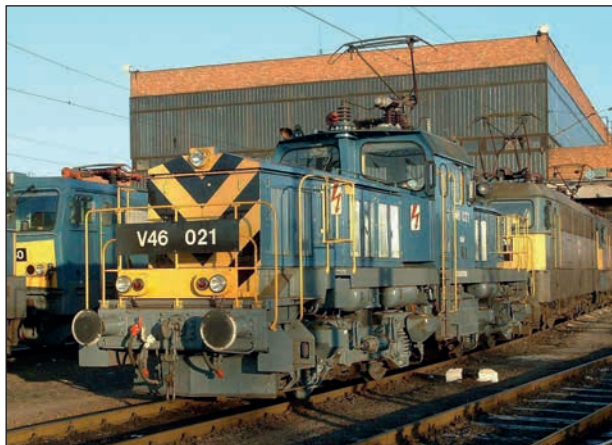
2. ábra: A MÁV V46 sorozatú Ganz-MÁVAG-ban gyártott villamos mozdony (Fotó: Kovács Károly)
