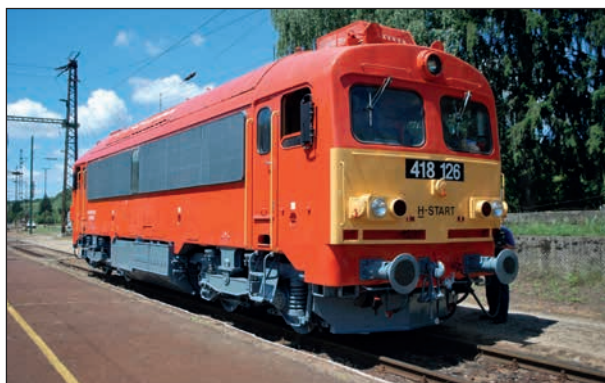
4. ábra: A Dombóvár Vontatási Telepen beépített és átfényezett 418 126-os Cammon Rail 3B csökkentett káros anyagszintű dízelmozdony (Fotó: Kovács Károly)
