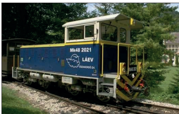
13. ábra: Mk48 típusú dízel-hidraulikus mozdony átalakítása dízel-villamos erőátvitelű, hibrid mozdonnnyá – Lillafüredi ÁEV, 2010
