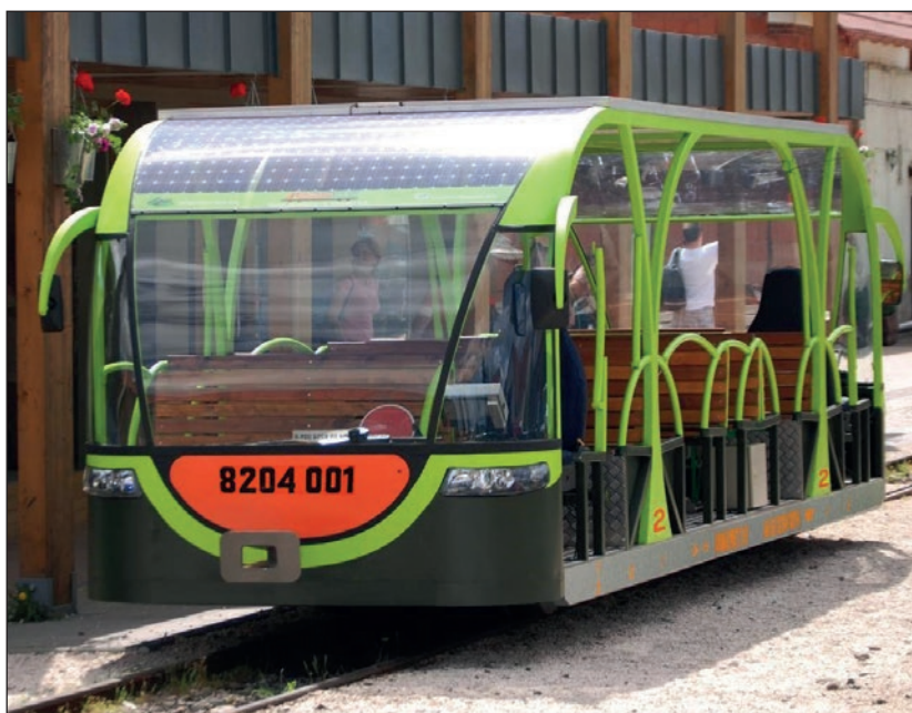
15. ábra: Környezetbarát, napelemes, akkumulátoros motorkocsi építése („Vili”) – Királyréti EV, 2013
