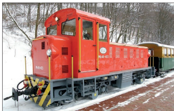
14. ábra: Mk48 típusú dízel-hidraulikus mozdony átalakítása dízel villamos erőátvitelű, hibrid mozdonnnyá – Szilvásvárad ÁEV, 2012
