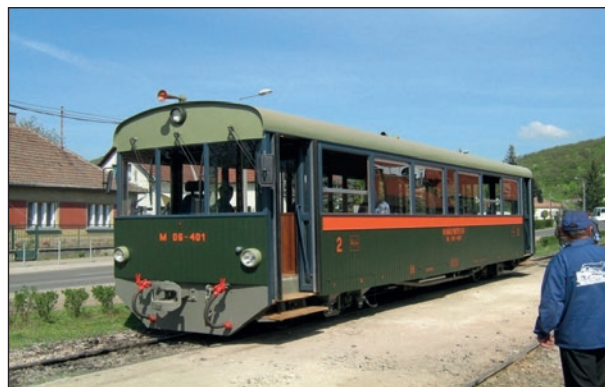
12. ábra: Jah típusú teherkocsiból átalakított dízel-hidrosztatikus motorkocsi („Tóbi”) – Királyréti EV, 2010
