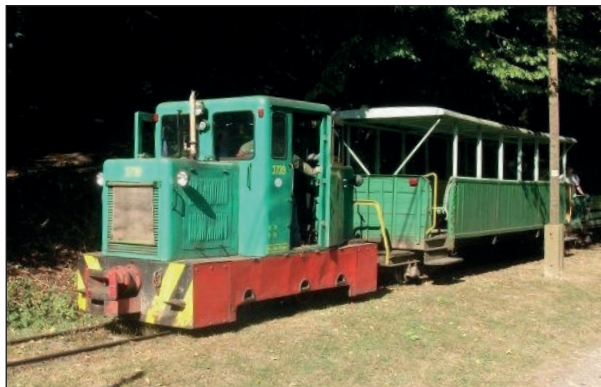
4. ábra: C50 típusú mozdony – Nagybörzsönyi EV, 2002
