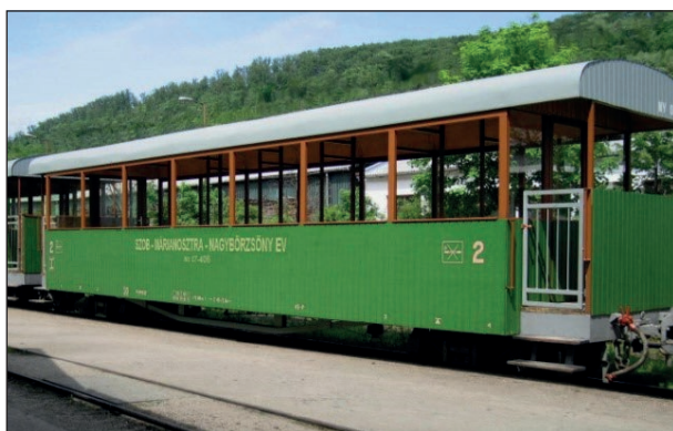
9. ábra: Jah típusú teherkocsiból átépített személykocsik – Börzsönyi Kisvasút – Szob, 2008
