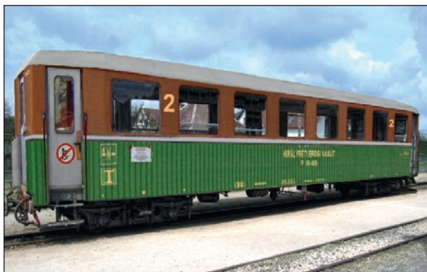
11. ábra: Bax típusú személykocsiból átalakított rendezvénykocsi – Királyréti EV, 2009
