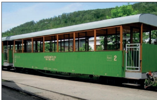
7. ábra: Jah típusú teherkocsiból átépített személykocsik – Királyréti EV, 2005
