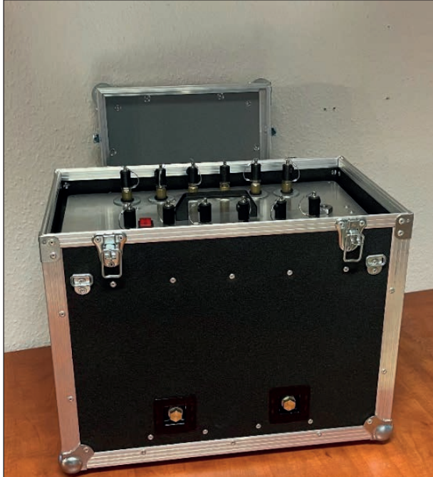
2. ábra: KISS motorvonat fékmérő berendezés
