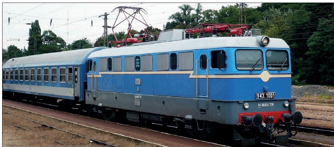
6. ábra: Az 1963-ban Németországból vásárolt 7 db Siemens, Aeg közösen gyártott V43 mozdonya, aktívan életben tartva betöltötte 40 évét és újabb felújítására sor került. 2007 után MÁV Trakció felújítása majd később MÁV-START-ra festették át, és eközben a szlovákiai kijárási engedély érdekében a Mirell vonatbefolyásoló berendezés hazai felszerelésére is sor került. A képen látható 1. V43-as 2023-ban is a közforgalomban dolgozik.
