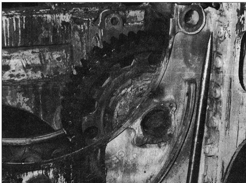
1. kép: blokkolt csapágyú közvetítő fogaskerekek
