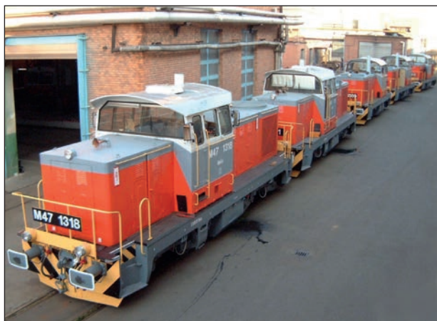
13. ábra: Az M47 MTU4000 motorokkal a MÁV Trakció Zrt számára korszerűsített dízelmozdonyok (Fotó: MVJ archívum)
