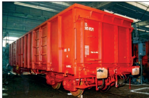
8. ábra: Eurofima hiteltől felújított Eas teherkocsi új szekrényvel (Fotó MVJ archívum)
