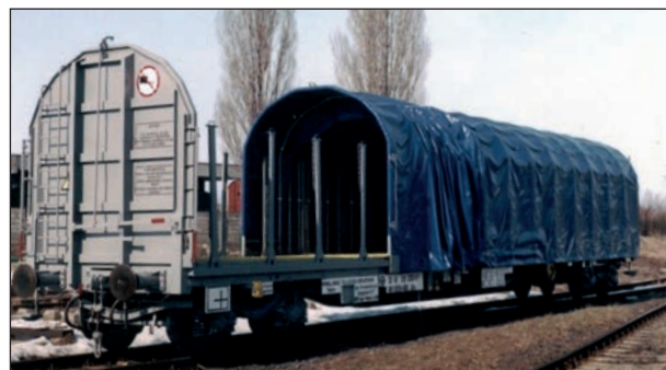
7. ábra: Eltolható ponyvatetős teherkocsi fejlesztése: (Fotó MVJ archívum)
