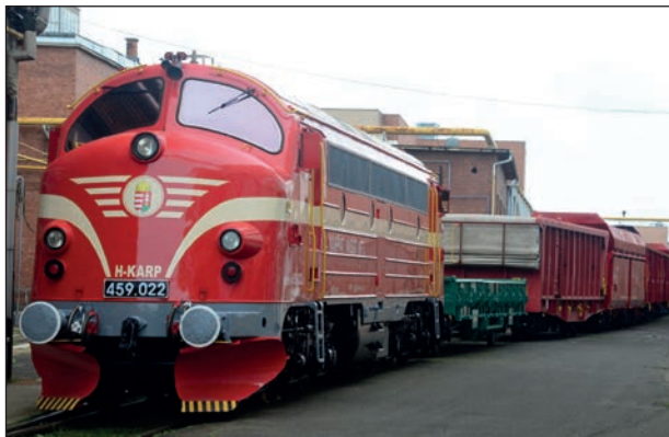
15. ábra: Kárpát vasúti Nohab dízelmozdonyának javítása és átfényezése Szombathelyen (Fotó MVJ archívum)
