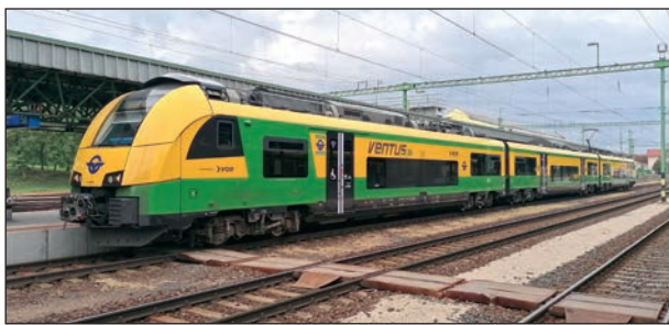
17. ábra: A GYSEV Siemens gyártmányú Desiro ML, azaz Ventus (Fotó: Bernátszki Gábor)
