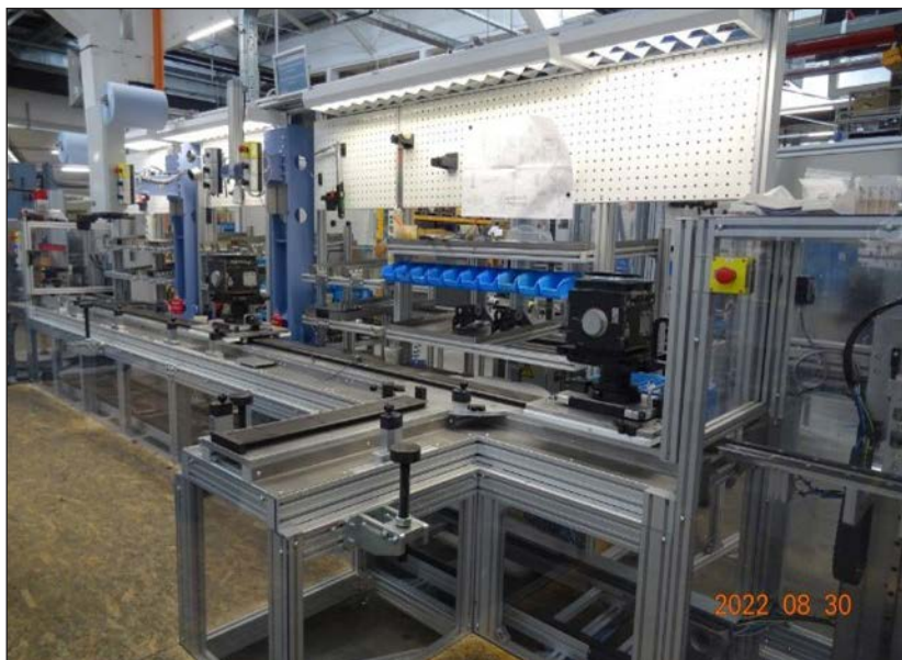
1. ábra: PEC7 tuskós fékblokk főösszeszerelése Figg 1 PEC7 tread brake units on the main assembly line Abb. 1. Hauptmontagelinie der PEC7 Klotzbremseinheiten
