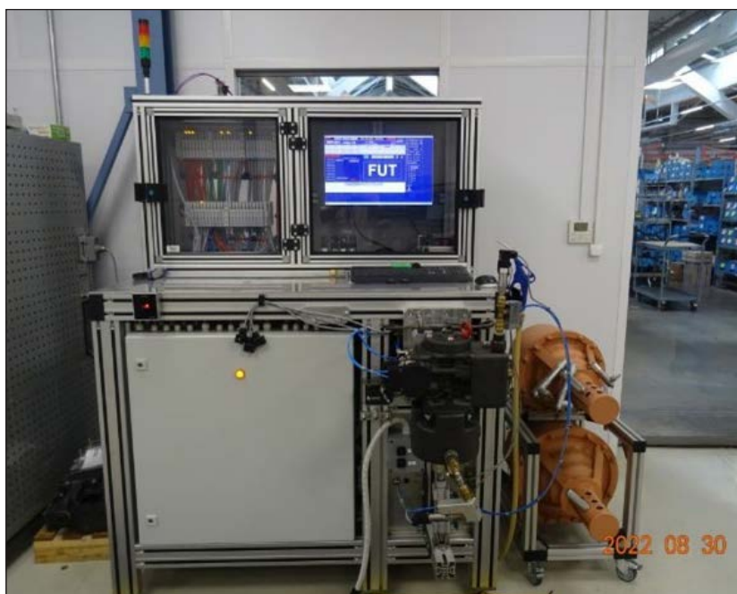
3. ábra: KE1A3,8SL típusú kormányselep próbapadi mérése Fig. 3. End of line test of a KE1A3,8SL distributor valve Abb. 3. Prüfstandskontrolle eines KE1A3,8SL Steuerventils
