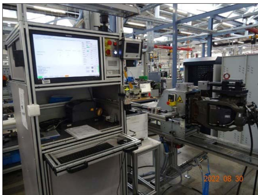
2. ábra: RZS tárcás fékegység próbapadi mérése Figg .2 End of line test of a RZS brake caliper unit Abb. 2. Prüfstandskontrolle einer RZS Bremszangeneinheit
