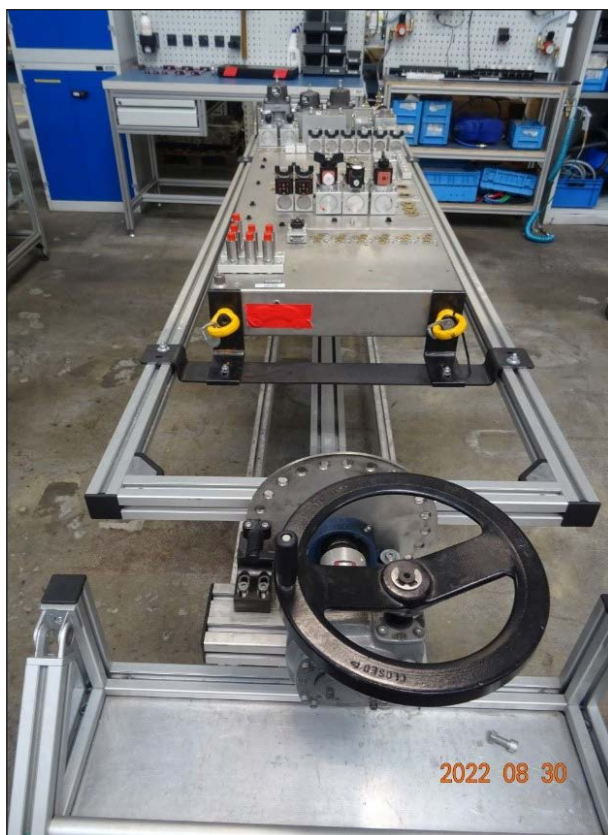
4. ábra: Fékpanel főösszeszerelése Fig. 4. Main assembly of a brake panel Abb. 4. Hauptmontage eines Bremstafels
