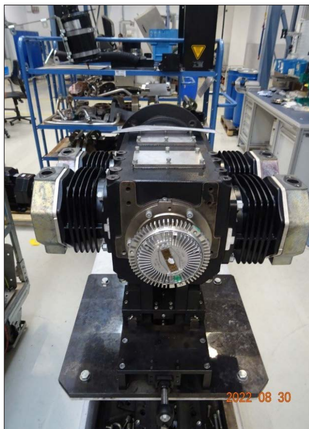
5. ábra: VV270-T kompresszor főösszeszerelése Fig. 5. Main assembly of a VV270-T compressor Abb. 5. Hauptmontage eines VV270-T Kompressors
