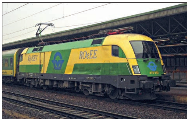
8. ábra: A GYSEV 502-es pályaszámú mozdonya, A Taurus 230 km/h végsebességre engedélyezve (Fotó: GYSEV)
