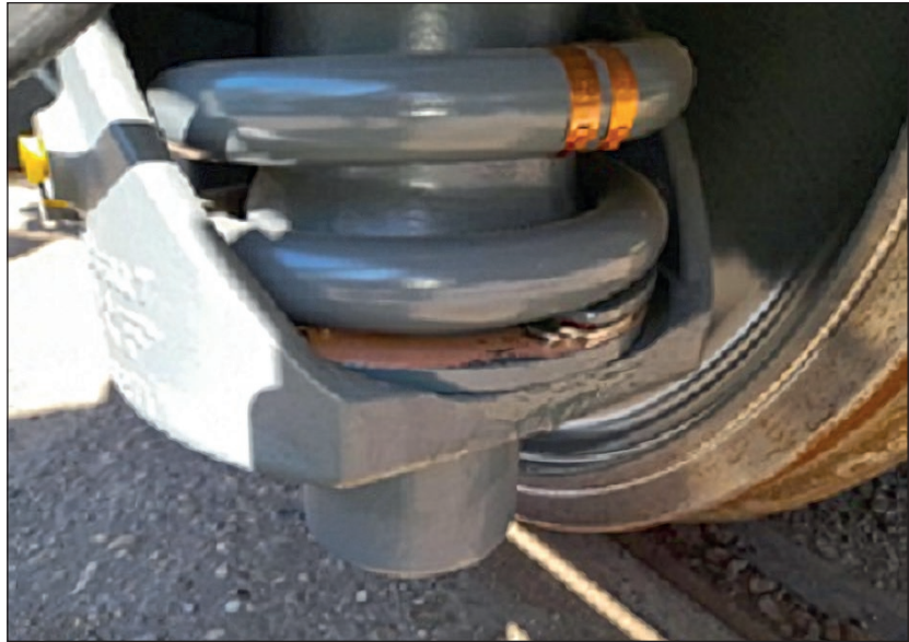
2. ábra: Alátétek a primer rugó alatt az SF 400 forgóvázban.
