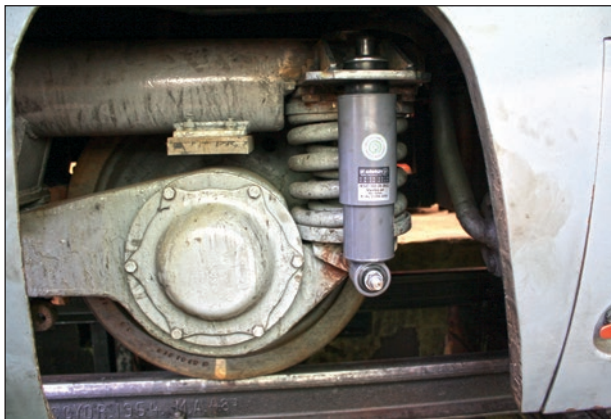
3. ábra: Az Mk45-2005 pályaszámú mozdony egyik forgóvázára felszerelt lengéscsillapító Hűvösvölgyben, 2021. június 28-án (fotó: Szécsény Tibor)
