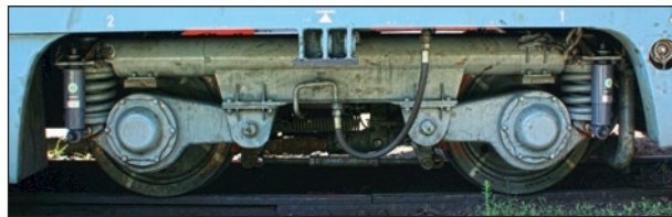
4. ábra: Az Mk45-2005 pályaszámú mozdony egyik forgóváza felszerelt lengéscsillapítókkal Hűvösvölgyben, 2021. július 2-án (fotó: Szécsény Tibor)
