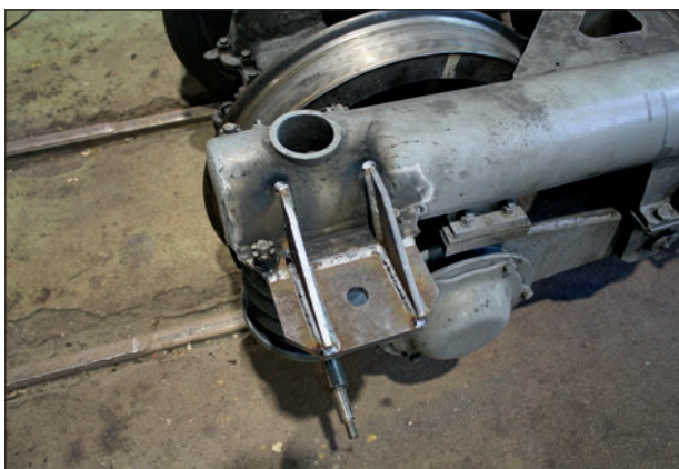
1. ábra: A lengéscsillapító beépítéséhez szükséges alkatrészek felhegesztve a forgóvázkerechez, alul az új csapszeggel, még lengéscsillapító nélkül Hűvösvölgyben, 2021. június 28-án (fotó: Szécsey Tibor)
