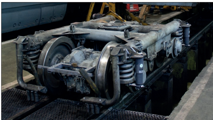
7. ábra: Az Mk45-2005 pályaszámú mozdony másik forgóváza, lengéscsillapítókkal és a nyomkarimakenő új tartókeretével felszerelve Hűvösvölgyben, 2021. június 28-án (fotó: Szécsény Tibor)
