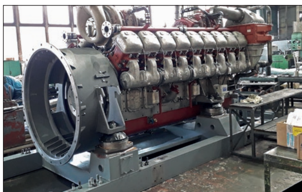
1. ábra Ganz Motor kft dízelmotorja gázüzemre is átállítható
