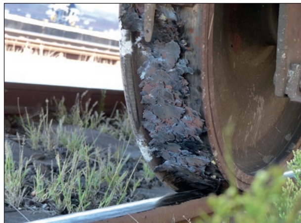
2. ábra: A 21 72 332 9186-3 számú teherkocsi egyik kerekén volt a képen látható kerékfelrakódás látható 2015-ben Dunakeszin. (fotó Murárik László)
