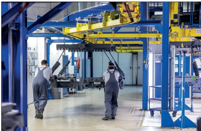
3. ábra: Forgóvázkeret mozgatása a Mátranováki gyár festőüzemében
