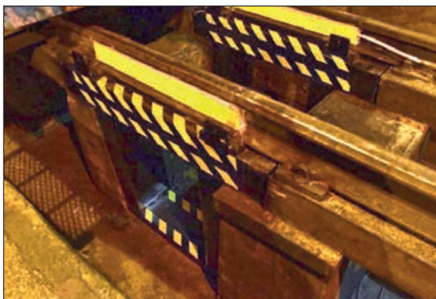
8. ábra: KT-25C típusú kerékterhelés mérő berendezés nyúlásmérő bélyegei a síngerecekre felszerelve (fotó: Csanádi Sándor)
