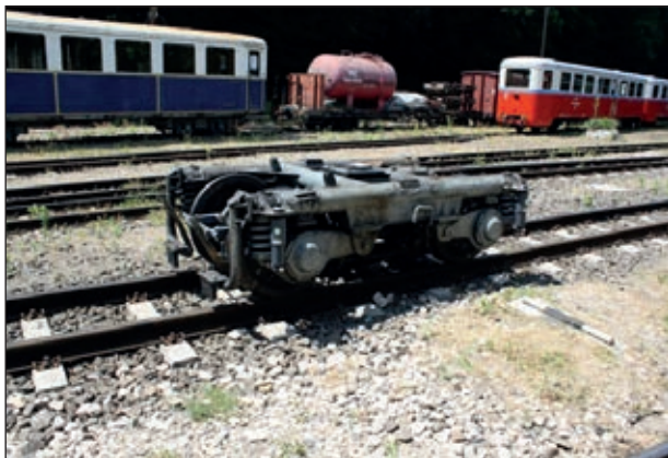
5. ábra: Az Mk45-2005 pályaszámú mozdony kiserelt forgóváza, lengéscsillapítókkal és a nyomkarimakenő új tartókeretével felszerelve Hűvösvölgyben, 2021. június 28-án (fotó: Szécsey Tibor)
