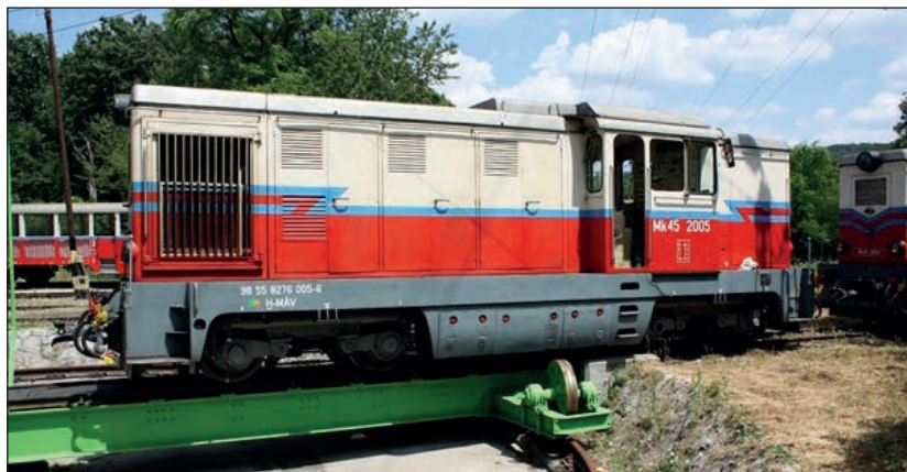
7. ábra: Az Mk45-2005 pályaszámú mozdony lengéscsillapítóval felszerelt forgóvázainak ívbeállítás szimulációja a hűvösvölgyi fordítókörön, 2021. június 28-án (fotó: Szécsey Tibor)
