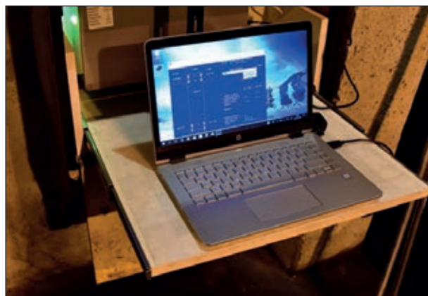
9. ábra: KT-25C típusú kerékterhelés mérő berendezés hagyományos számítógépről működtethető kiértékelő és minősítő szoftvere (fotó: Csanádi Sándor)
