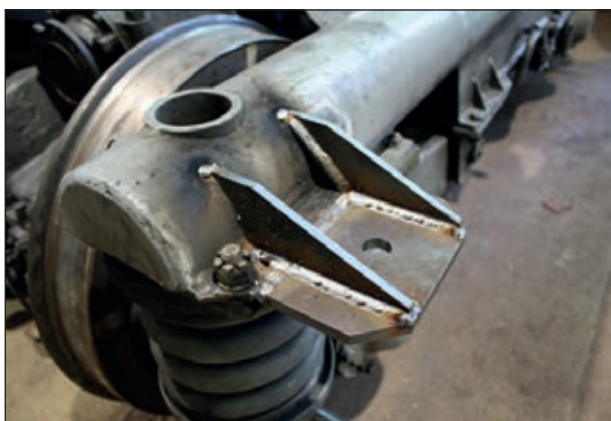
3. ábra: A lengéscsillapító beépítéséhez szükséges alkatrészek felhegesztve a forgóvázkeretre, még lengéscsillapító nélkül Hűvösvölgyben, 2021. június 28-án (fotó: Szécsény Tibor)
