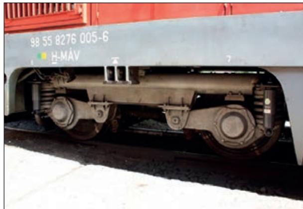
6. ábra: Az Mk45-2005 pályaszámú mozdony egyik forgóváza felszerelt lengéscsillapítókkal Hűvösvölgyben, 2021. július 2-án (fotó: Szécsey Tibor)
