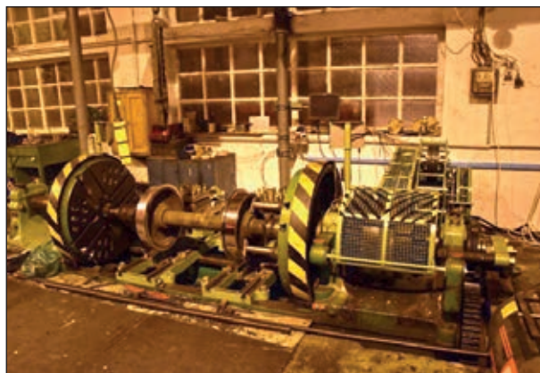
2. ábra: A hűvösvölgyi műhely korszerűsített és felújított kerékpáresetergája működés közben (fotó: Csanádi Sándor)
