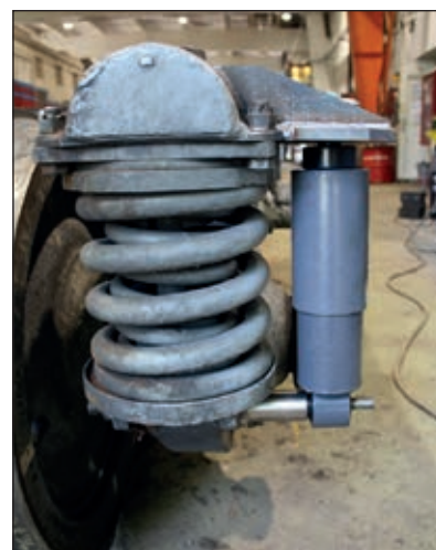
4. ábra: Az Mk45-2005 pályaszámú mozdony egyik forgóvázára felszerelt lengéscsillapító Hűvösvölgyben, 2021. június 28-án (fotó: Szécsény Tibor)
