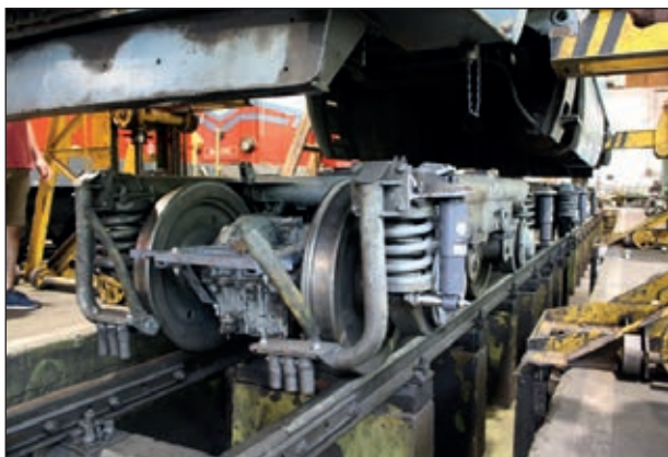
1. ábra: Az Mk45-2005 pályaszámú mozdony forgóvázai lengéscsillapítókkal és a nyomkarimakenő új tartókeretével felszerelve, beépítés közben Hűvösvölgyben, 2021. június 28-án (fotó: Szécsény Tibor)
