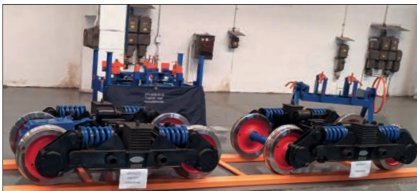
3. ábra: Az UHFV hajtott és UFFV futó forgóváz protótípusa (Fotó: Sörös Árpád)
