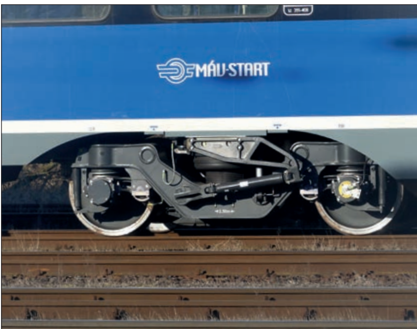
11. ábra: A KISS futó forgóváza (Fotó: Murárik László)
