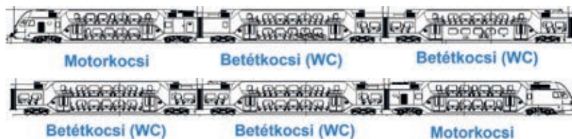
5. ábra: A hatszemes emeletes motorvonat rajza Vonathossz 156 m, 600 ülőhely
