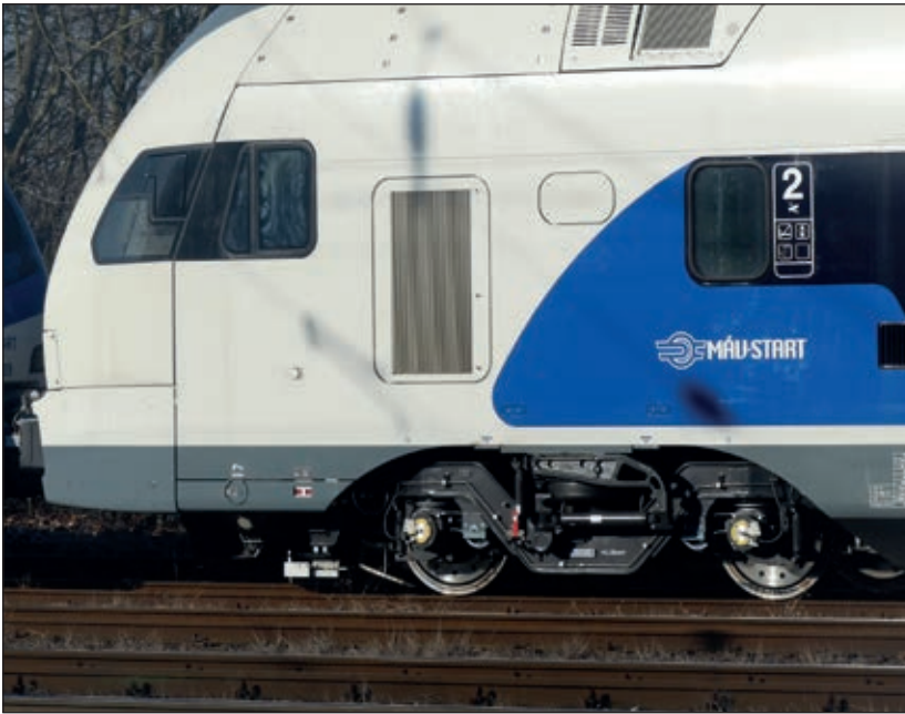
10. ábra: A KISS hajtott forgóváza (Fotó Murárik László)
