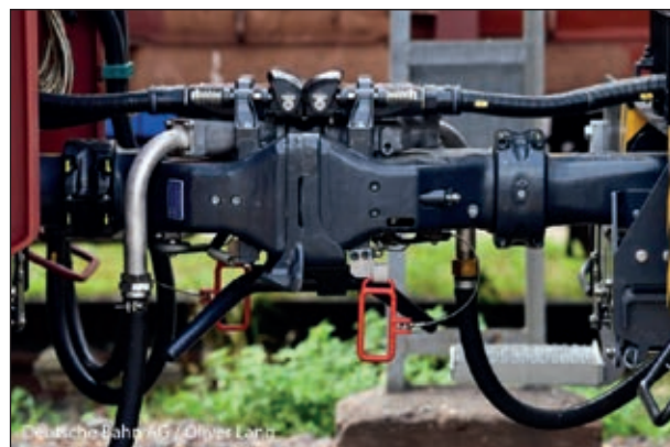
A képen a Voith CargoFlex típusú, teherkocsikra kifejlesztett digitális csatlakozó, ütköző- és vonókészüléke látható a DB tesztelés közben.
