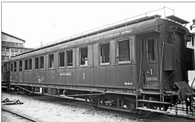
4. sz. ábra: A MÁV IV s jellegű, Aa 1 100196 pályaszámú, étkező szakasszal is rendelkező I. osztályú kocsija már a C.F.R. tulajdonában, felújításra várva a Koprivnice-i vagongyárban. Az eredeti fotón jól olvasható a kocsi étkező szakaszos oldalán a „BUFFET KOCSI” felirat és az „Fm. 13.03.1919” revíziójel, mely egyértelműen bizonyítja, hogy a kocsi nem a később Romániának ítélt területen élte meg a fegyverszünetet, hiszen még 1919. márciusában a „Főműhelyben” – azaz az északi főműhelyben – kapott fővizsgát. Ebből következik, hogy a kocsit a román csapatok 1919 őszi országfosztása során hurcolták el. (Konrád Zoltán gyűjteménye)
