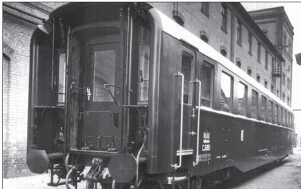
13. ábra: A MÁV Ca 5851 félnehéz RIC forgalmú kocsi fényképe a Ganz gyár udvarán
