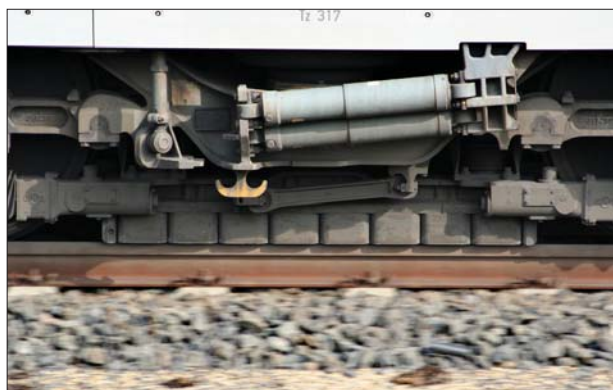
18. ábra: ICE 3 örvényáramú sínfék (Szerk. megjegyzése: Az örvényáramú fék a MÁV FKI közreműködésével Magyarországon is tesztelve volt) Abb.18 – ICE3 – Wirbelstrombremse (Bem. d. Redakteurs: Die Wirbelstrombremse war auch in Ungarn unter Mitwirkung von FKI getestet.) Fig 18 ICE 3 eddy current rail brake (Remark of the editor: The eddy current brake was tested also in Hungary by the contribution of MÁV FKI
