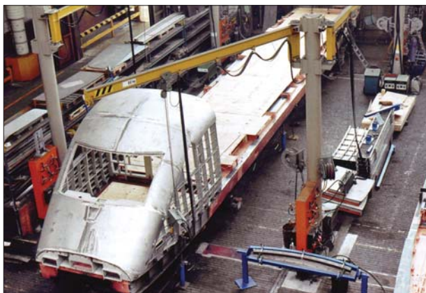
1. ábra: ICE 1 TK szerelése, Krauss-Maffei Abb.1. ICE1 Triebkopf – Montage, Krauss-Maffei Fig 1. The construction of ICE 1 TK at Krauss-Maffei
