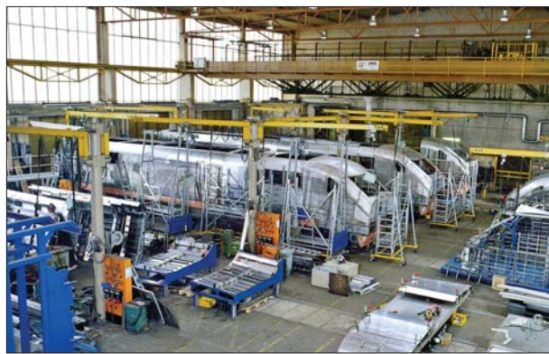
4. ábra: ICE 2, vonófejek szerelése, München-Allach (Krauss-Maffei) Abb.4 – Triebkopf-Montage, München-Allach (Krauss-Maffei) Fig 4. construction of the ICE 2 power heads in München-Allach (Krauss-Maffei)
