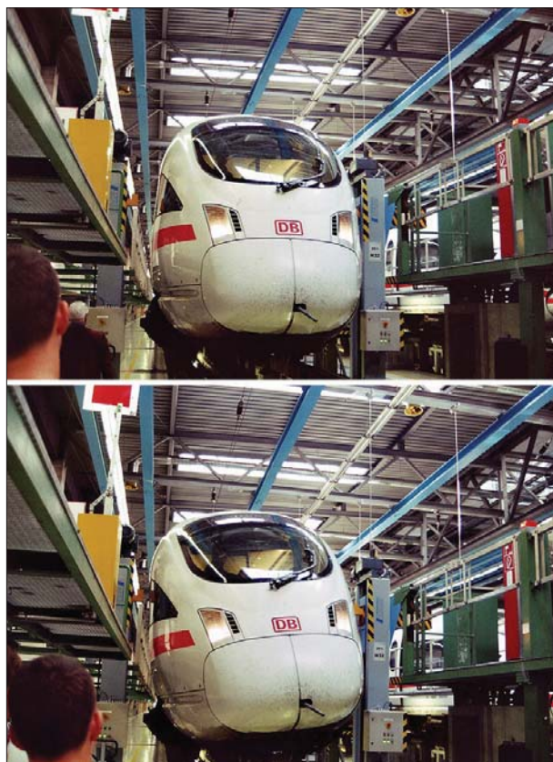
19. ábra: ICE-TD szerelvény normál és bedöntött helyzetű kocsiszekrényel Abb.19 – ICE-TD Garnitur – mit Wagenkasten in Normal- und Neigeposition Fig 19. ICE-TD trainset with the car bodies in normal and tilted position
