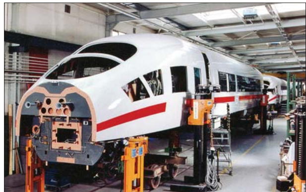
16. ábra: ICE 3, vonófej (végkocsi) szerelése München (ADTranz) Abb.16 – ICE3 - Triebkopf-Montage (Endwagen), München (ADTranz) Fig 16. Construction of the ICE 3 power head in München at ADTranz
