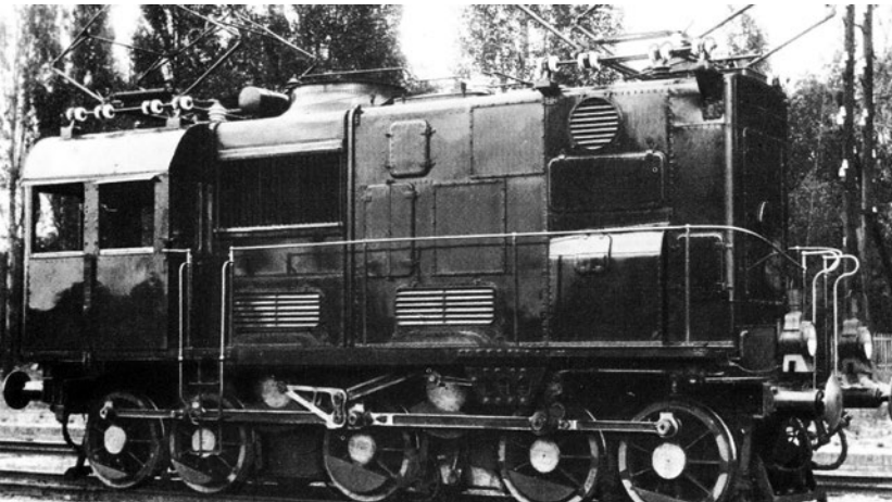
5. ábra: A V50-es Kandó féle fázisváltós próbamozdony 1928-ból Abb. 5: Die Kandó'sche Phasenwandler-Probelokomotive V50 aus dem Jahre 1928 Fig 5: Class V50 Kandó type phase converter test locomotive in 1928
