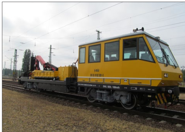
10. ábra: UFDJ típusjelű darus jármű Abb. 10: Kranfahrzeug Typ UFDJ Fig 10. On track machine (OTM) type UFDJ equipped with crane
