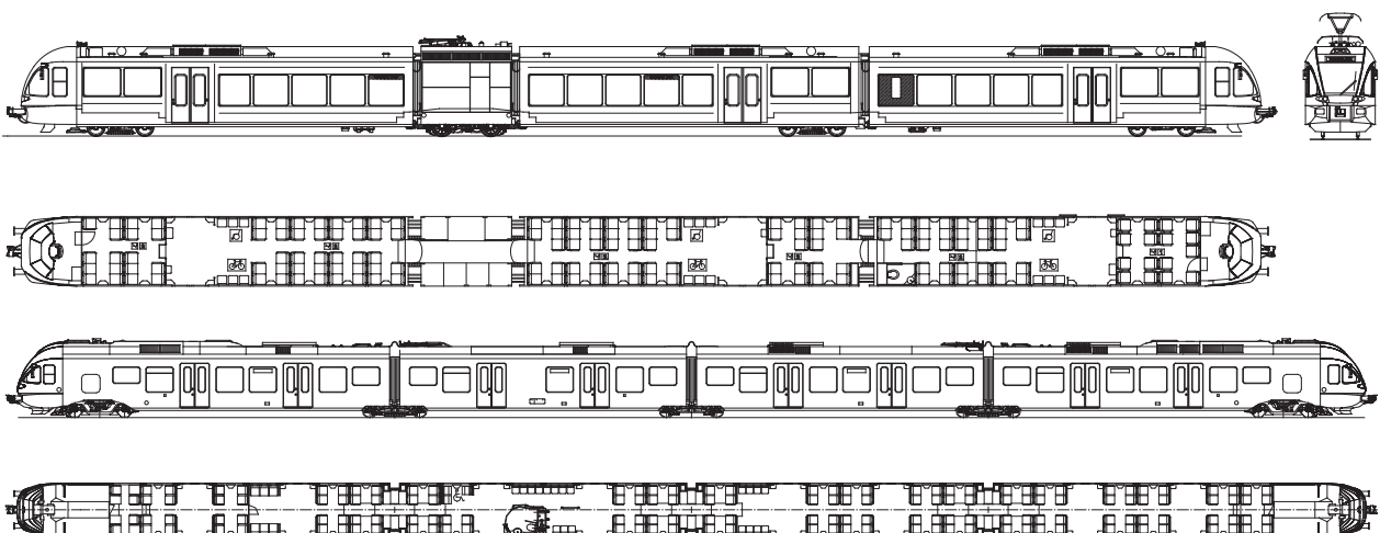
3. ábra: A GTW és a FLIRT koncepció rajza Abb 3.: Konzept - GTW und FLIRT - Zeichnung Fig 3. The concepts of the GTW and the FLIRT
