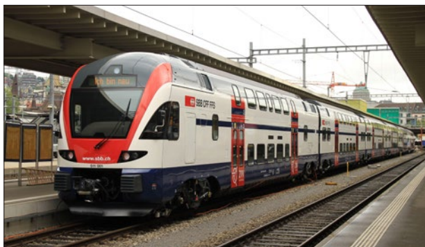
6. ábra: A Stadler KISS emeletes kivitelű villamos motorvonata Abb. 6: KISS – der Doppelstock-Elektrotriebzug von Stadler Fig 6. The KISS, – the double decker EMU of the Stadler Rail Group Fotó: Michael Burger
