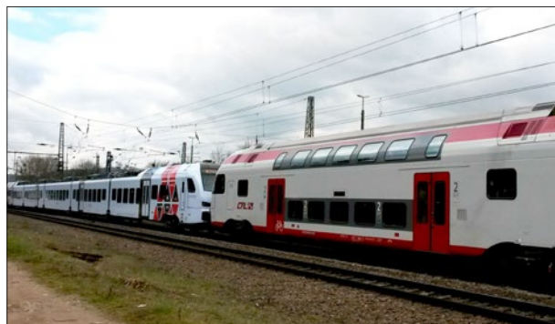
7. ábra: A FLIRT és a KISS 2015-től együttműködésre képes Abb. 7: FLIRT und KISS – ab 2015 für Mehrfachtraktion geeignet Fig 7. The FLIRT and the KISS can be operated together in multiple traction from 2015 Fotó: Michael Burger
