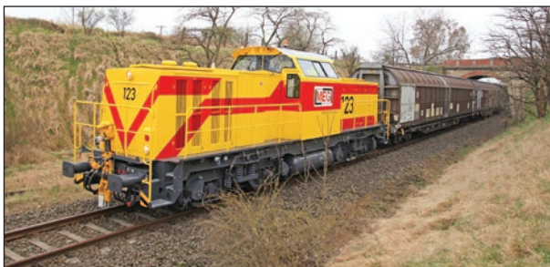
1. ábra: Az Alstom cég magánvasutak megrendelésére korszerűsített V100 alapú dízelmozdonya
