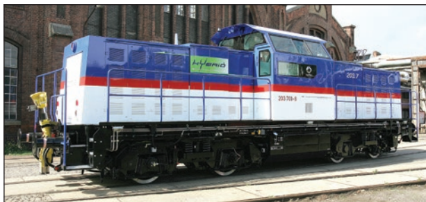
1. ábra: Az Alstom cég magánvasutak megrendelésére korszerűsített V100 alapú dízelmozdonya
