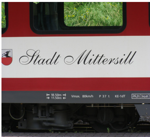
5. ábra: Feliratok az SLB 760 mm nyomközű személykocsijainak oldalán. V_{\max} = 80 km/h. A MÁV vonalain 1949-ben forgalomba állított Bax sorozatú személykocsik szerkesztési sebessége is már 80 km/h volt.
