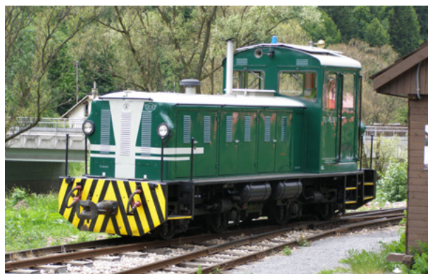
3. ábra: Dízel-villamos erőátvitelűre átalakított Rába M 042 gyári típusjelű mozdony.
