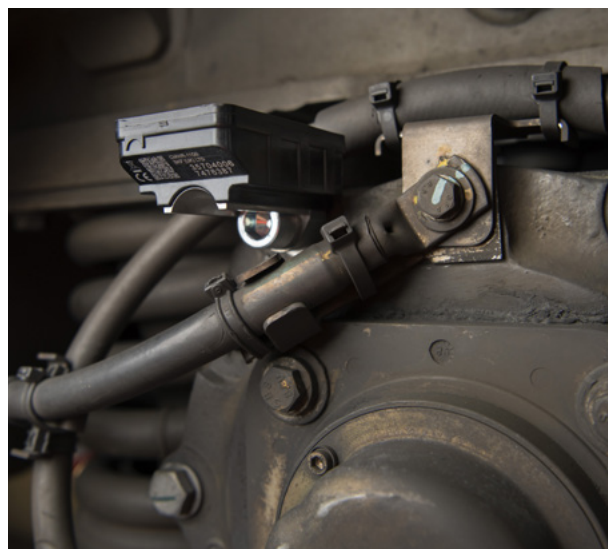
11. ábra: Az SKF két digitális be- és kimenettel ellátott LRM2 az alacsony kenőanyag-szint kijelzésére
