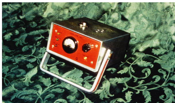
6.b. ábra: Vezérlőkör diagnosztikai készülék (folyamatos feszültség változtatással)
