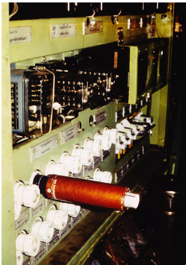
6.a. ábra: Vezérlőkör gyorseszter – diagnosztikai készülék (feszültség lépcsőkkel)
