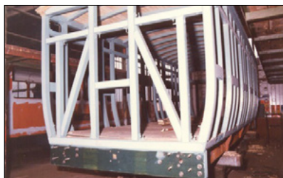
7. ábra: elkészült a faváz
