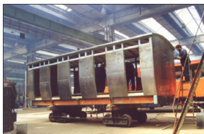
8. ábra: Az újjáépített kocsi fényezés előtt
