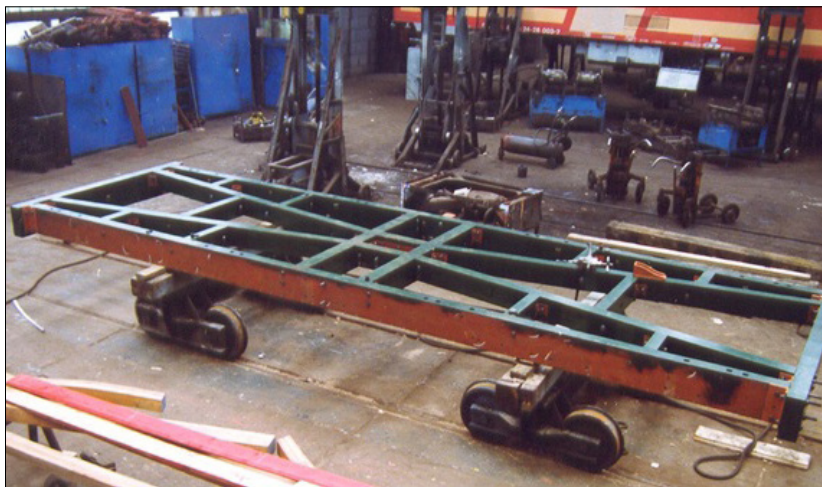
3. ábra: A kész faszervezetü alváz
