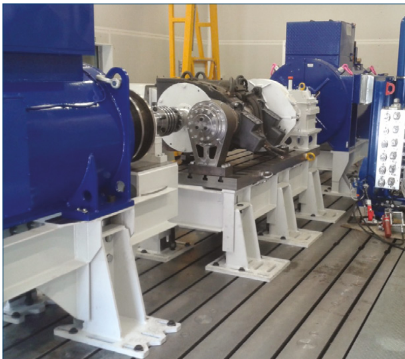
4. ábra: A Wikov MGI próbapad – mozdony kerékpár tengelyhajtómű tesztelése
