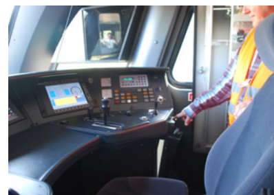
12. ábra: A véletlen kapcsolási hiba ellen eltakart világítás kapcsolók (Fotó: Kovács Károly)
