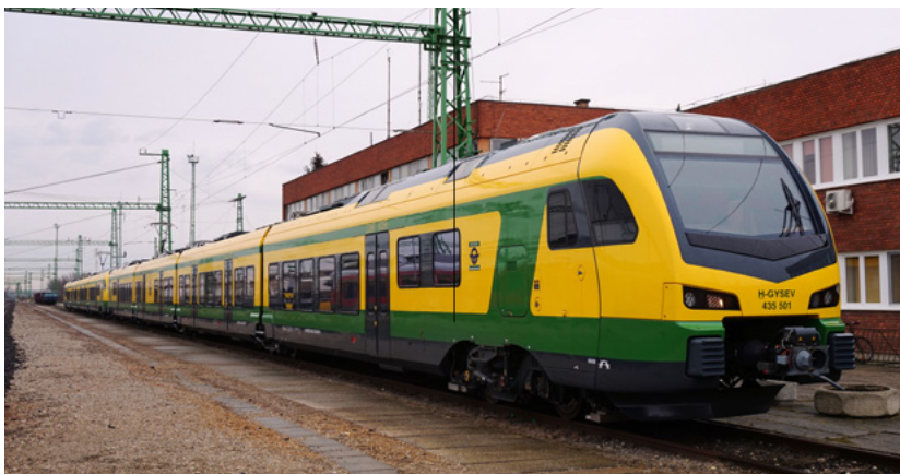
2. ábra: A FLIRT 3 hosszabb és biztonságosabb orrsze Abb. 2: FLIRT 3 – der verlängerte und Crash-sichere Frontpartie Fig. 2 The longer and safer front end of FLIRT 3
