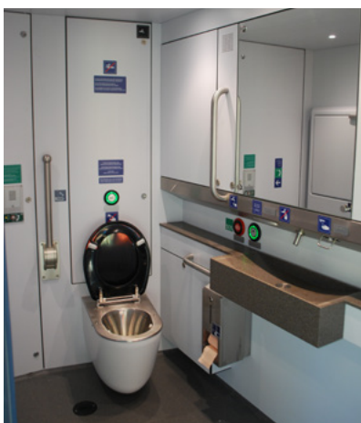
5. ábra: A kerekesszékekkel járható és pelenkázó asztallal felszerelt mozgássérültek használatára méretezett, nagyméretű WC (Fotó: Kovács Károly) Abb. 5 Das für Rollstuhlfahrer begehbare und mit Wickeltisch ausgerüstete Großraum-WC (Aufnahme: Kovács, Károly) Fig 5 Large-sized toilette of special areas for wheelchairs designed to use for persons with disabilities and reduced mobility and equipped with baby nappy changing facilities. (Photo: Károly KOVÁCS)
