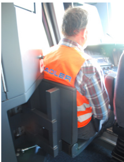
11. ábra: A FLIRT 3 vezetőfülke oktatófülkéjében használatban (Fotó: Kovács Károly) Abb. 11: FLIRT 3 Fahrerkabine – Besetzer Schulungssitz (Aufnahme: Kovács, Károly) Fig 11 The instructor seat of FLIRT 3 driver's cab in use. (Photo: Károly KOVÁCS)
