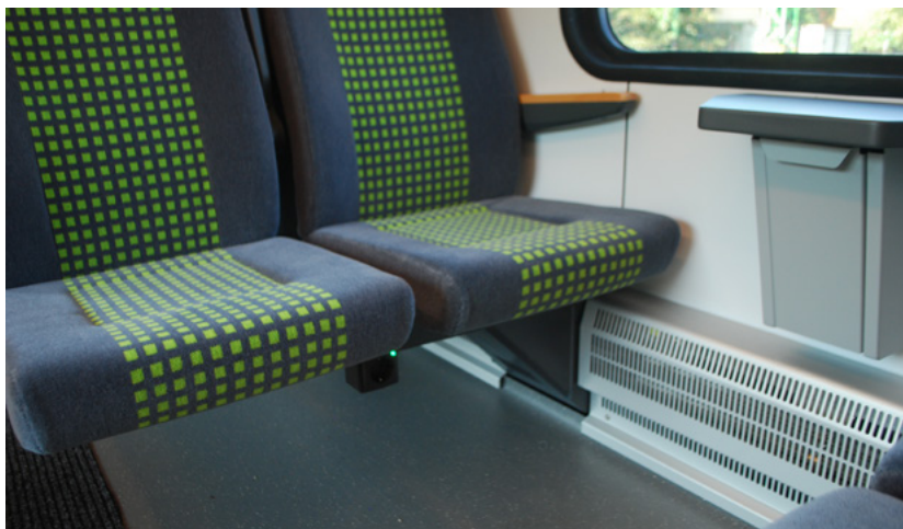
6. ábra: A FLIRT 3 ülései alatt elhelyezett 230V-os dugaszolóaljzat működésére LED-es zöld fényű lámpa figyelmeztet. (Fotó: Kovács Károly)
