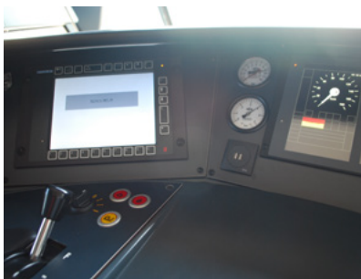
10- ábra: A vezetőasztal bal és jobb oldala, valamint kilátás a vezetőfülkéből (Fotó: Kovács Károly) Abb. 10: Fahrerpult - rechte, bzw. linke Seite, sowie Aussicht aus der Fahrerkabine (Aufnahme: Kovács, Károly) Fig 10 Left and right side of the driver's desk, and the view from the cab (Photo: Károly KOVÁCS)
