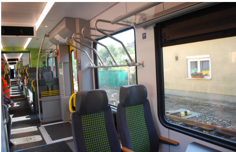
14. ábra: A kerékpárparkók és a kerékpártároló hely (Fotó: Kovács Károly) Abb. 14.: Fahrradhooken und Abstellplatz für Fahrräder (Aufnahme: Kovács, Károly) Fig 14 Bicycle hooks and bicycle storage place (Photo: Károly KOVÁCS)
