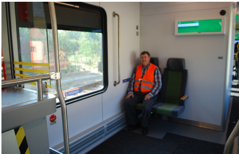
13. ábra: A többcélú tér babakocsik és kerekesszékek számára (Fotó: Kovács Károly) Abb. 13.: Mehrzweckraum für Kinderwagen und Rollstühle (Aufnahme: Kovács, Károly) Fig 13 Multi-purpose space for baby buggies and wheelchairs (Photo: Károly KOVÁCS)
