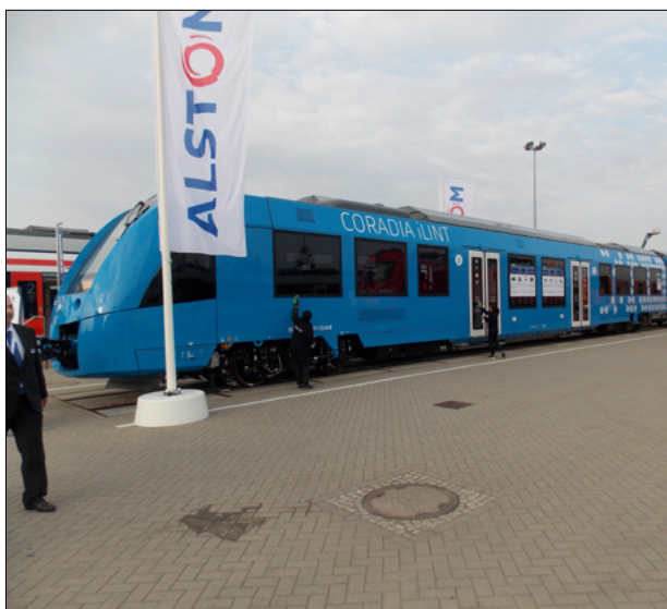
28. ábra: Coradia iLint üzemanyagcellás-akkumulátoros motorvonat 2016. Berlin (fotó: Elek László)
