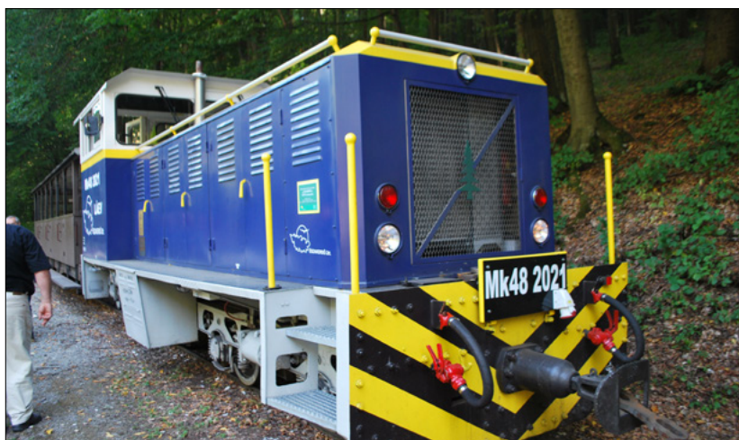
35. ábra: a LÁEV hibrid dízel-akkumulátoros mozdonya, (a szerző felvétele)
