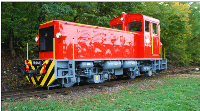
36. ábra: a SZÁEV korszerűsített hibrid dízel-akkumulátoros erőforrású mozdonya (a szerző felvétele)
