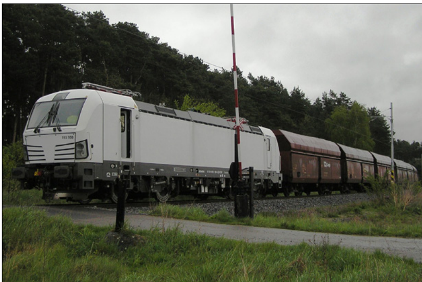
20. ábra. A Siemens Vectron beépített kis teljesítményű dízelmotorral (Fotó Szécsey István)
