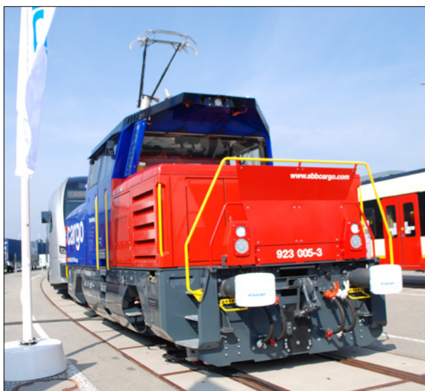
26. ábra: a Stadler által az SBB-nek gyártott az E3/3 Berlinben 2014 szeptemberében kiállított villamos-dízel tolatómozdony (a szerző felvétele)
