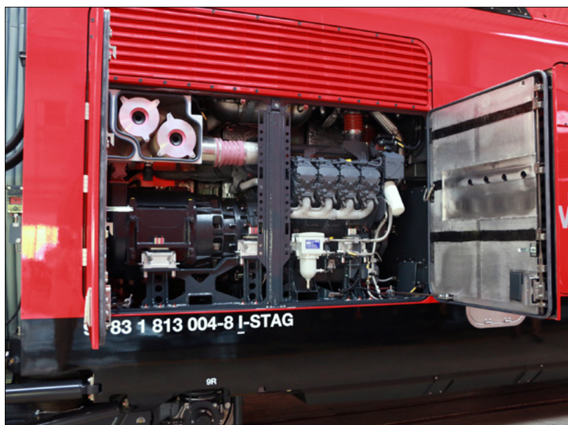
18. ábra: FLIRT duális motorvonaton a dízelmotoros egység elhelyezése (Fotó Stadler)
