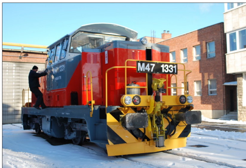
32. ábra: A maig legkorszerűbb MÁV M47-es részecszeszűrős, fél automatikus vonókészülékes korszerű dízelmotoros és rádiós távirányítású fejlesztett mozdony 2010-ben készült el (a szerző felvétele)
