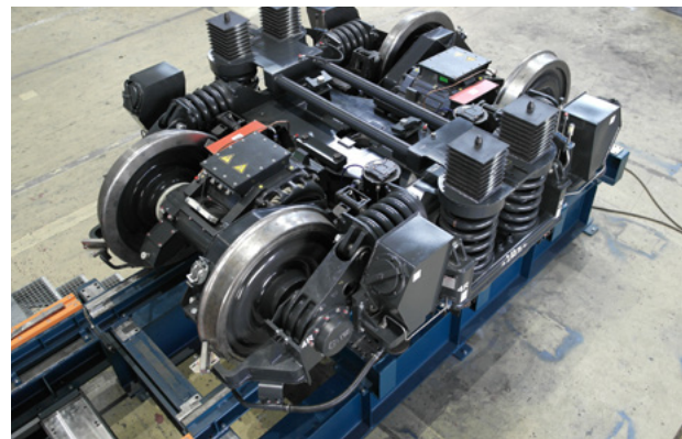
1. ábra: Az elkészült Ganz 170.1-10-N1 típusú forgóváz a CMI DE1200 típusú mozdony részére
