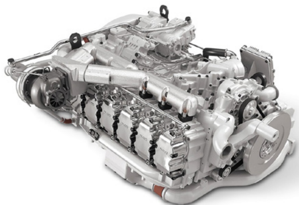
1. ábra: a Voith Rail Engine
