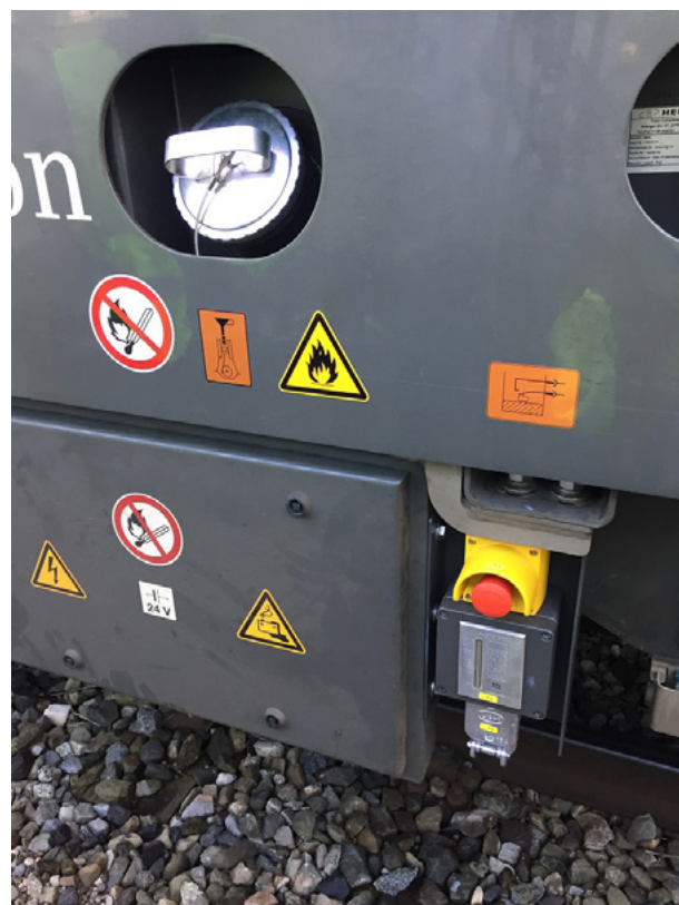
4. ábra: A Vectron villamos mozdony dízelmotorjának tankoló csöcsönkjá
