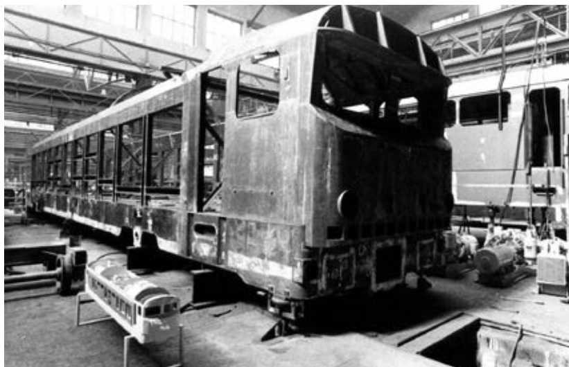
7. ábra: A DVM10-1 gyári jellegű mozdony szekrény szerkezete
