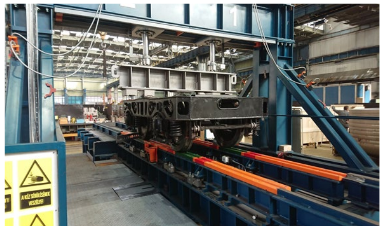
20. ábra: A felújított Ganz forgóváz a mérőpadon (fotó: Rényi Ferenc)
