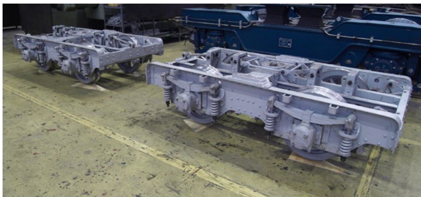
7. ábra: Lillafüredi felújított futó forgóvázak (fotó: Fehér Imre)
