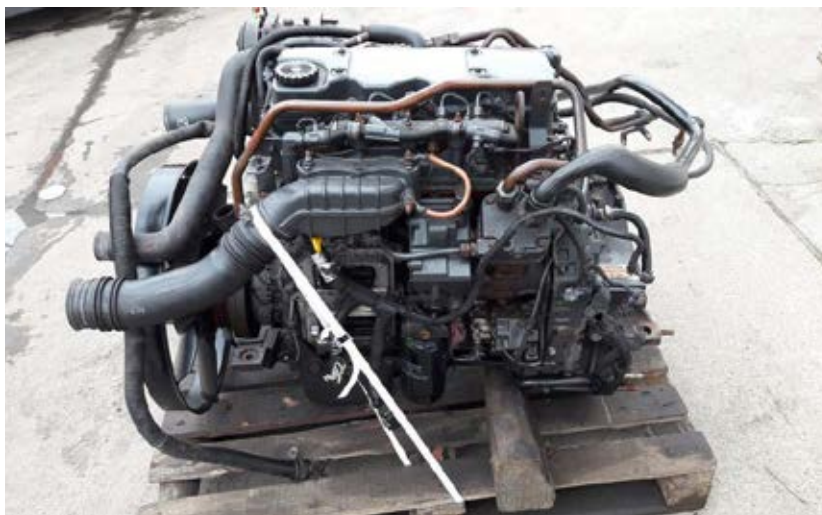
8. ábra: Az M 06-401 motorkocsi erőforrása Euro 4-es dízelmotor
