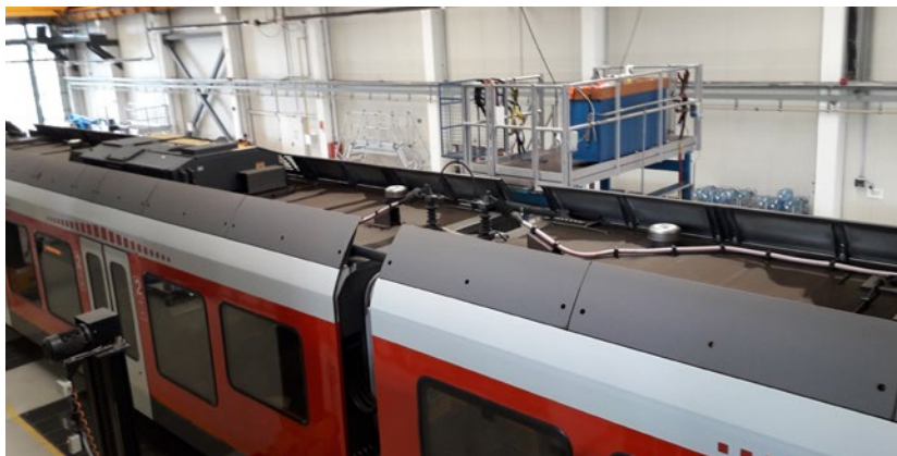
10. ábra: A tetőelemek ellenőrzésére szolgáló állvány (Fotó: Kovács Károly)
