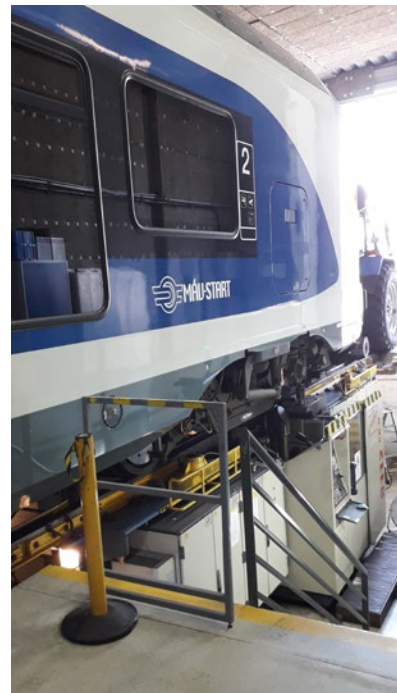
4. ábra: A spanyol TALGO padlóalatti kerékeszterga üzemben 2020-ban (Fotó: Kovács Károly)
