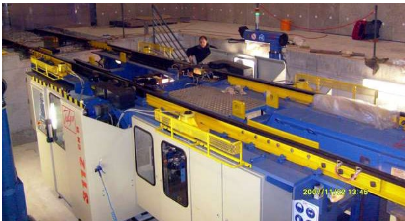
5. ábra: A pusztaszabolcsi kerékpár eszterga vágány a Talgo kerékesztergával 2007-ben. (Fotó Stadler)
