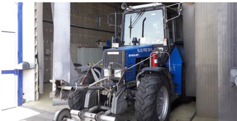
7. ábra Motorvonat beállítása a karbantartó vágányra kétéltű vontatóval történik (Fotó: Kovács Károly)
