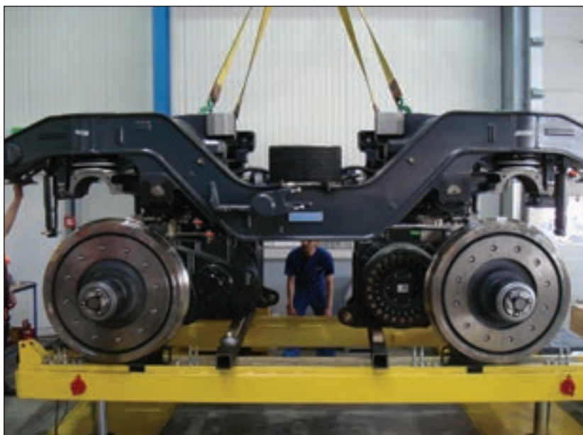
11. ábra: Hajtott forgóváz szerelése – a forgóvázkeret felhelyezése a (hajtott) kerékpárokra
