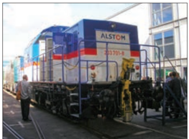
10. ábra: A DB egyik V100 sorozatú mozdonyából átépített hibrid mozdonyt a gyártó tolatásbiztonságot javító félautomata kapcsolókészülékkel is ellátta. A kiállításon ezt követően bemutatott tolatómozdonyokon a félautomata kapcsoló berendezés szériatartozékká vált.
