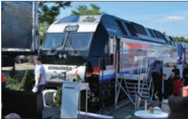
17. ábra: Az amerikai nagy tengelyterhelésű vasútvonalra gyártott Alp kétmotoros dízelmozdony a 2010. évi kiállításon mutatkozott be.
