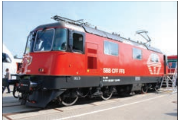
25. ábra: Egy közel 50 éves 1964-től gyártott Re420 sorozatú svájci villamos mozdony látható, felújított állapotban 2012-ben Berlinben kiállítva.
