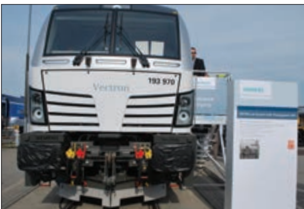
28. ábra: 2014-ben mutatkozott be az ún. "utolsó mérföld" felsővezeték nélkül közlekedni tudó, dízelmotorral is felszerelt Vectron villamos mozdony
