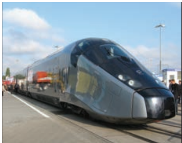
14. ábra: Az Altom új nagysebességű 360km/h sebességre tervezett villamos motorvonata az AGV 2008-ban mutatkozott be.
