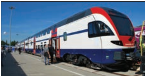
19. ábra: A Stadler KISS emelete motorvonat volt a svájci járműgyártó 2010. évi másik újdonsága
