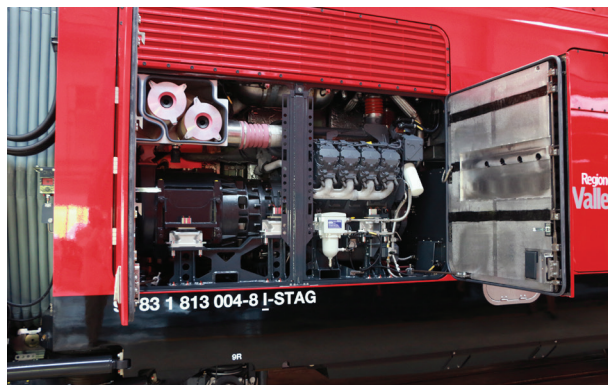
2. ábra: A Stadler hibrid FLIRT dízelerőforrása
