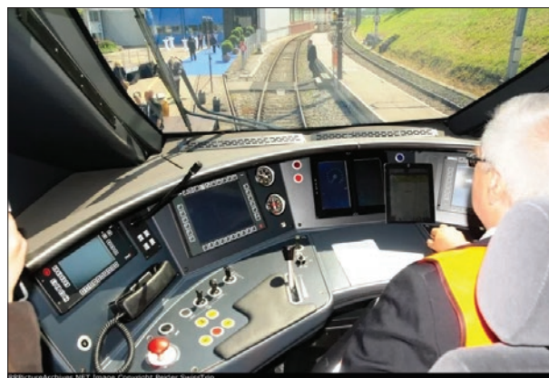
10. ábra: A Stadler Girunió nagysebességű motorvonat vezetőállása
