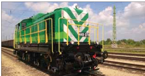
11. ábra: A MOL DVM-2 mozdony 2016. évi felújítása során új Ganz 6 hengeres 6GM185V-VG-CRA motorral lett felszerelve (fotó: Vasútgépészet gyűjteménye)
