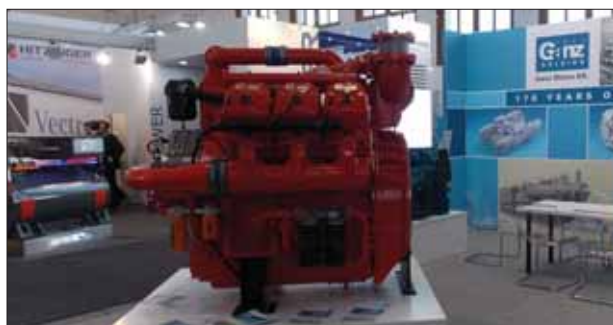
10. ábra: A 6 hengeres CR dízelmotor a berlini kiállításon (Fotó: Horváth András)
