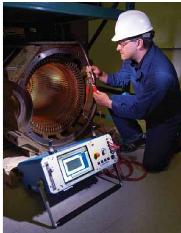
20. ábra: SKF Baker AWA-IV vontatómotor-vizsgáló berendezés
