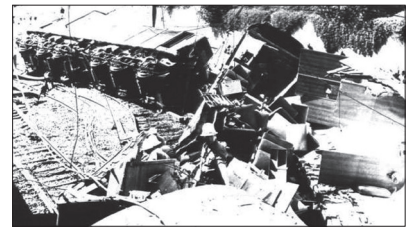
4. ábra A nyomtáv-bővülés rendkívül súlyos balesetet okozott a Sidney környéki Parramatta városban 1977. január 18-án
