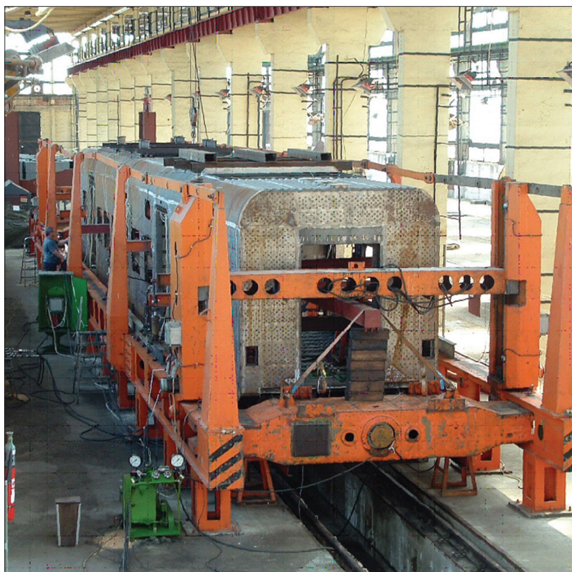
3. ábra Az SBB új, motorvonat betétkecsi szekrényszilárdság mérése Szolnokon
