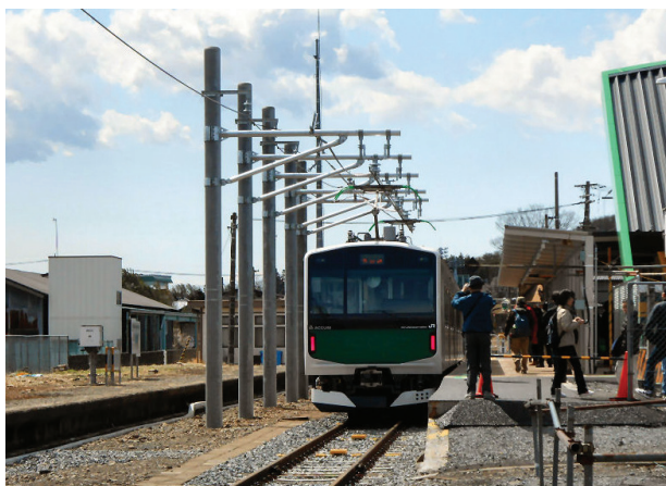
14. ábra A JR Est közforgalomú villamos-hibrid motorvonata
